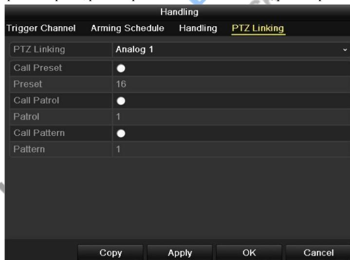
Slika 8.10 Podešavanje PTZ linkovanja na alarmnom ulazu
