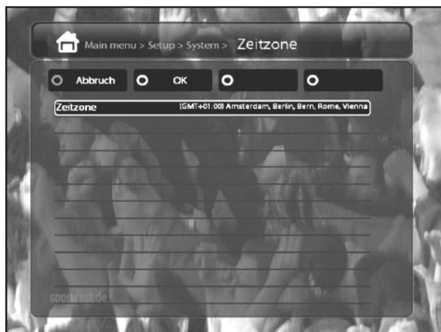
Tipkama **LIJEVO/DESNO** nađite vremensku zonu koju želite koristiti za Vu+. Pritiskom na **ZELENO** potvrdite odabir i tako memorirajte izmjenu postavke
